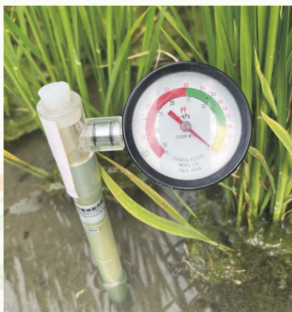
圖2.於田間設置土壤水勢計觀測，pF值不宜超過1.5。
