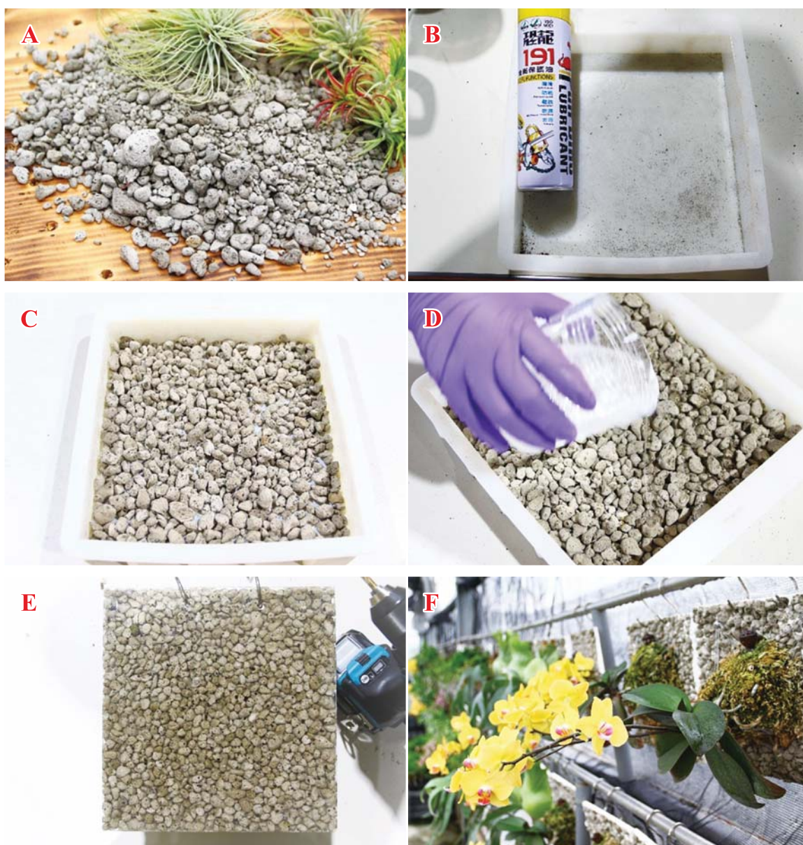
圖1.本試驗手作火山浮石植生板之建構：(A)臺東海岸打撈之火山浮石為淡灰色(B)模具噴施脫模劑(C)將火山浮石排入模具內(D)均勻灌注配製好之膠劑(E)凝固後脫模並打出吊掛孔(F)實際上板栽培植物。
