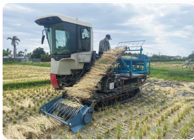
圖12. 研成之稻草田間編織機械田間操作情形
