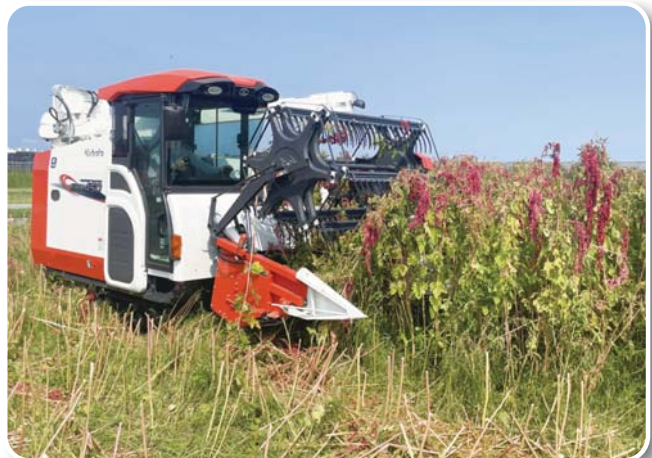
圖10. 臺灣藜機械收穫時提高割取高度會有較佳的收穫效果
