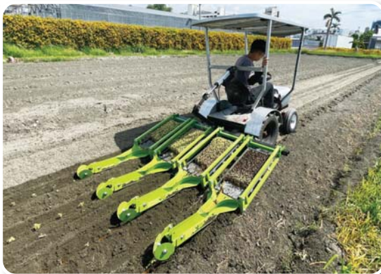
圖7. 四行式連續紙穴盤移植機田間試驗情形
