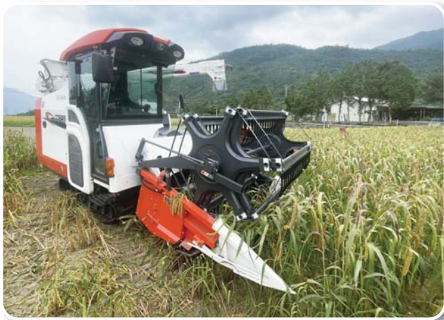
圖9. 小米使用雜糧聯合收穫機收穫情形
