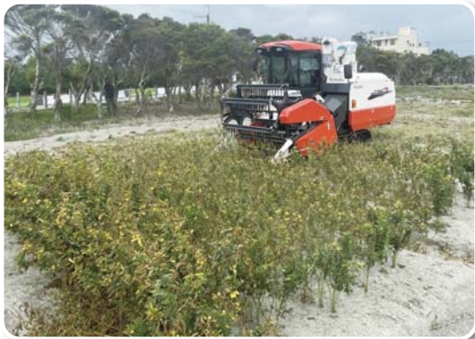
圖11. 樹豆密植機械收穫試驗情形
