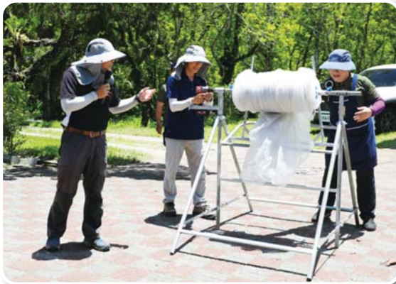
圖6. 可收折防猴網捲收機械操作情形
