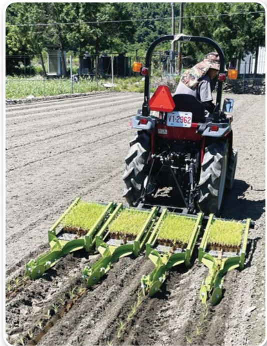
圖8. 以曳引機附掛四行式連續紙穴盤移植機作業情形
