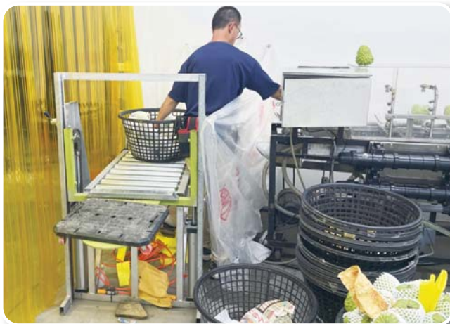
圖3. 果籃抬升裝置安裝於清潔機械前方
