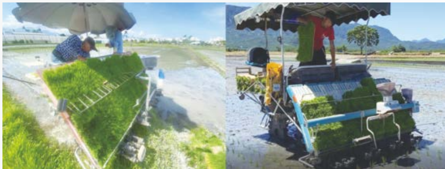
圖1. 左為傳統插秧機，右為利用插秧機附掛深層施肥裝置，將緩效性肥料埋入秧苗旁約6-10公分深度位置。
