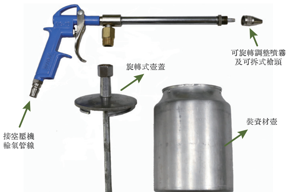
噴資材槍(壺)組之分解構造
