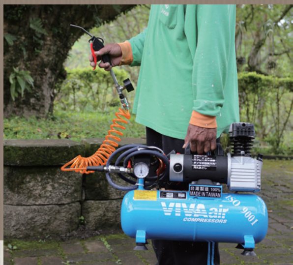
圖 39. 使用較輕便之直流電手提式小型空壓機，增加操作靈活性與機動性。
