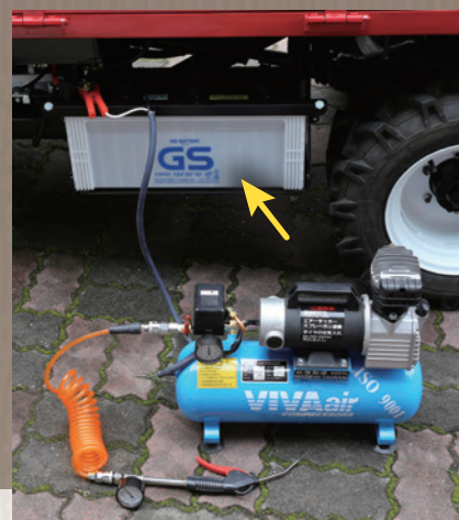
圖 40. 手提式空氣壓縮機使用 12V 直流電，可利用「攜帶式救車電瓶」（左）或搬運車輛「蓄電池」（右）供應電力。
