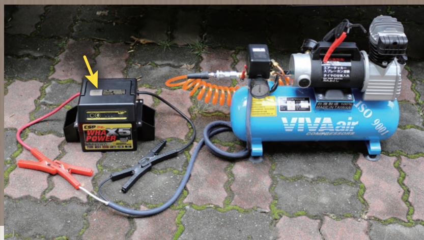
圖 40. 手提式空氣壓縮機使用 12V 直流電，可利用「攜帶式救車電瓶」（左）或搬運車輛「蓄電池」（右）供應電力。
