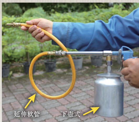
圖 30. 噴漆槍頭改裝以高壓軟管延伸較方便操作
