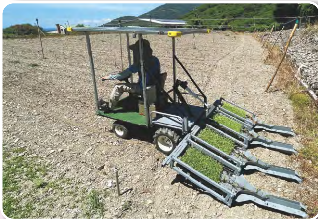
圖5.四行式連續紙穴盤移植機械田間試驗情形
