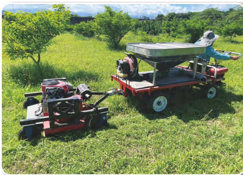
圖2.「附掛式施肥撒布裝置」與「附掛式割草裝置」同時搭載於搬運車使用
