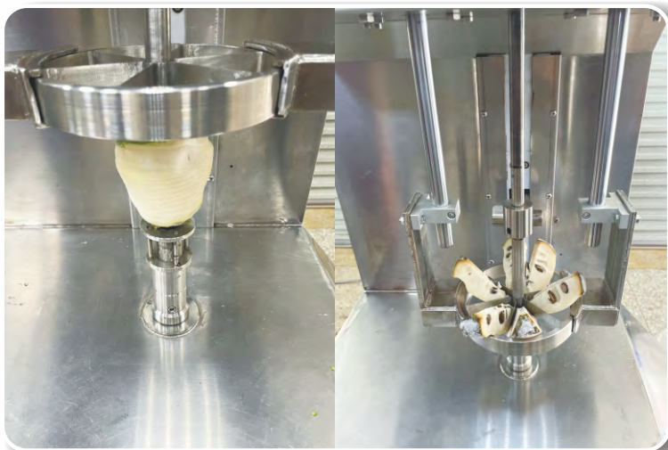
圖4.冷凍鳳梨釋迦於機械上削皮及分切之情形
