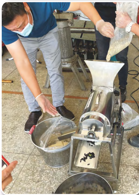
圖9.木鼈果假種皮分離機械進行鳳梨釋迦肉籽分離試驗
