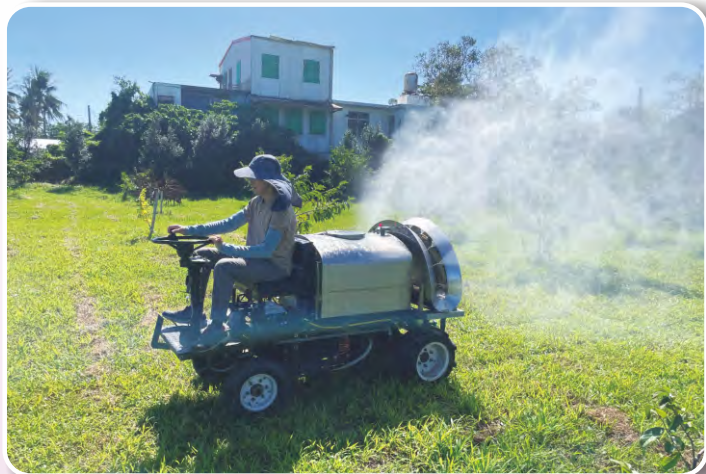
圖1.乘坐式果園電動噴霧機械田間使用情形
