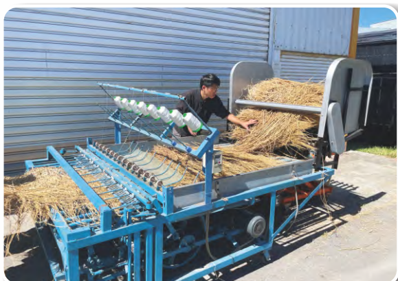
圖6. 研成之稻草鋪平機械安裝於稻草編織上之操作情形
