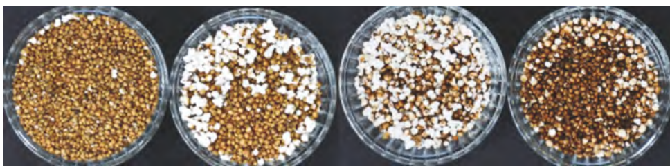
圖13.未調整含水率之珍珠粟直接以膨發鎗膨發，膨發狀況不佳。(由左至右分別為壓力7psi、8psi、9psi、10psi)
