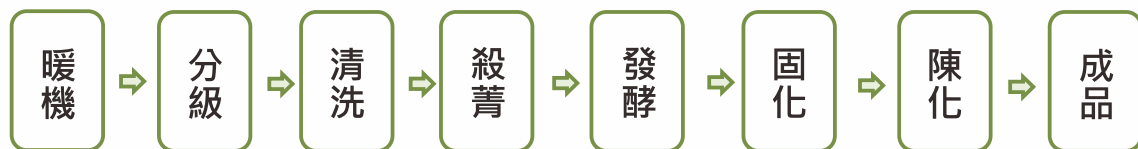
圖9.香草莢機器製莢加工流程
