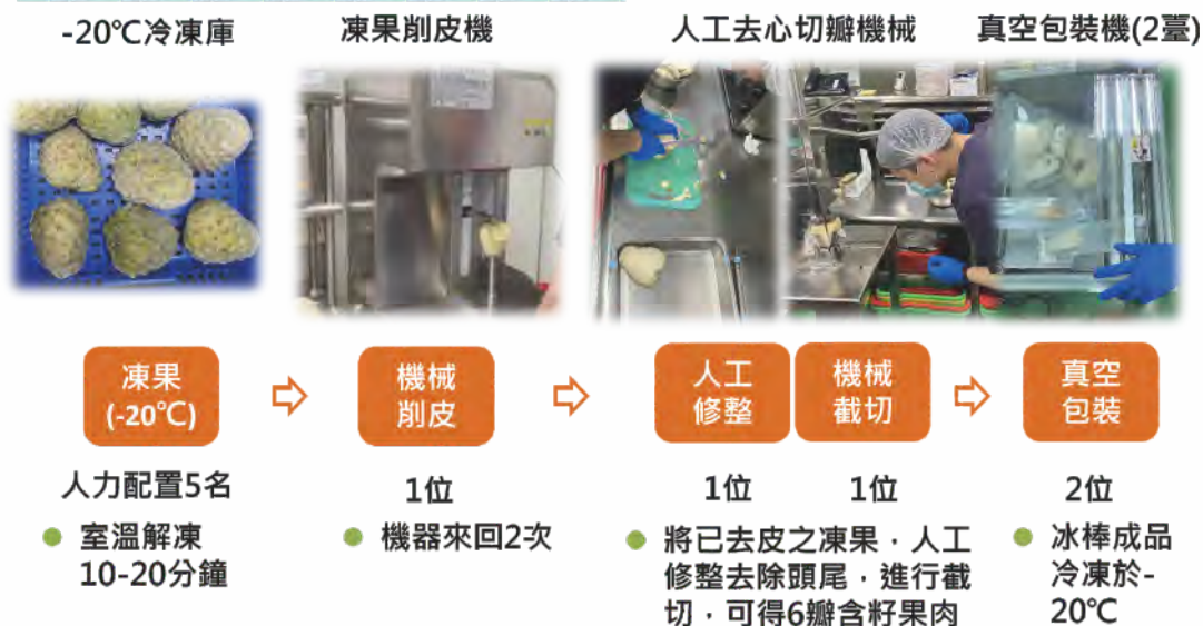
圖4.鳳梨釋迦冷凍果機械加工處理流程
