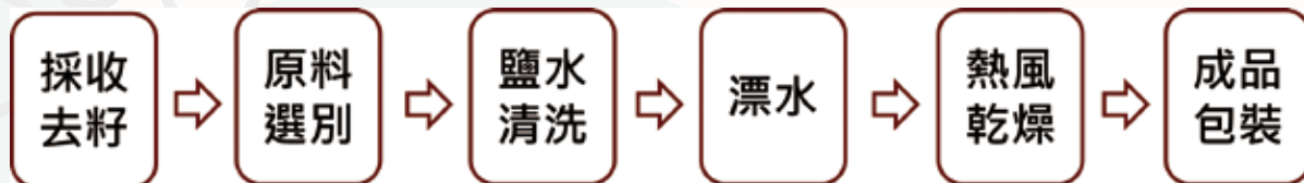
圖 2. 洛神葵乾燥加工流程
