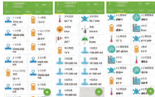
圖2、田間智慧灌溉平台即時監控田間各項觀測資料
