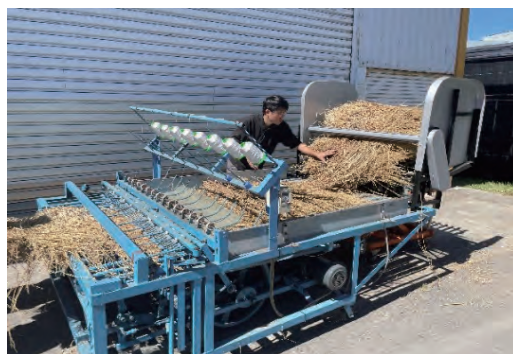
圖2、稻草鋪平機械配合編織機械可單人作業
