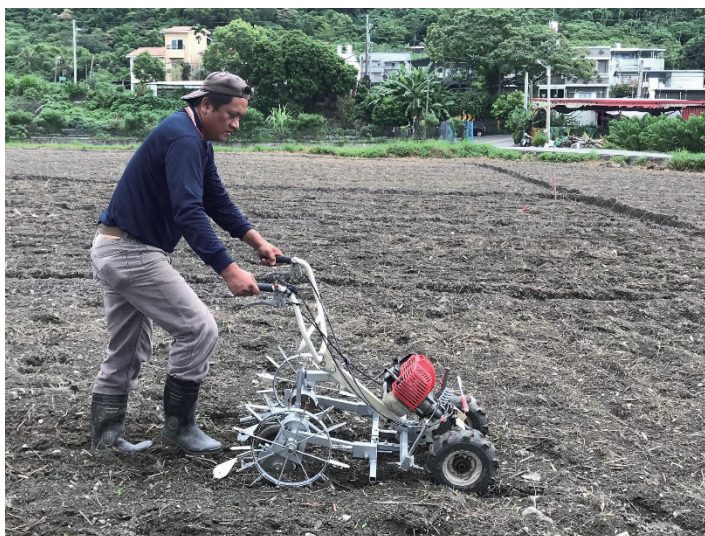
圖2. 雙行自走式播種機田間播種情形。
