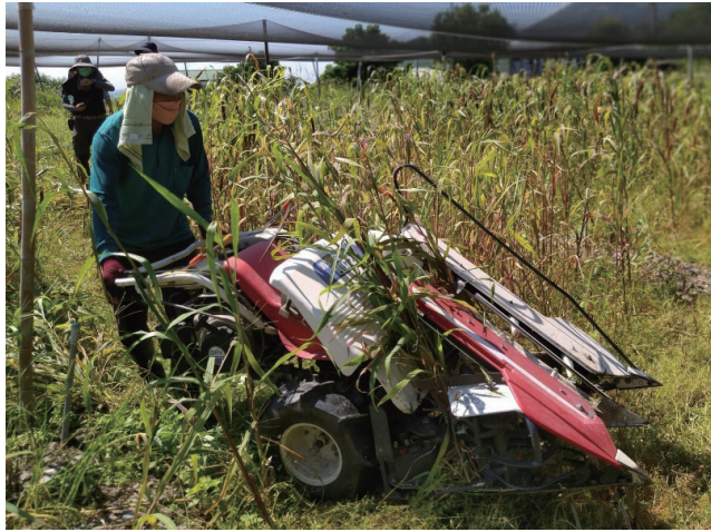
圖8. 改良二行式小型割稻網綁機進行小米收割情形。 Fig. 8. Improved harvesting and bundling machine.
