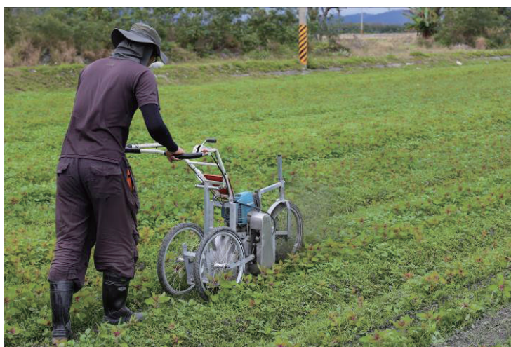
圖5. 單行式糧雜行間除草機田間作業情形。 Fig. 5. Single row weeder.
