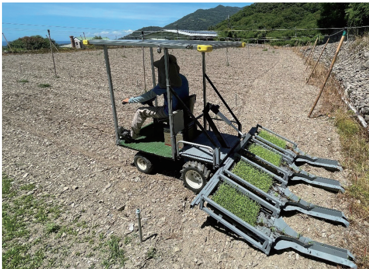
圖3. 四行式連續紙穴盤移植機械田間試驗情形。 Fig 3. Four-row paper chain pot transplanting machine.
