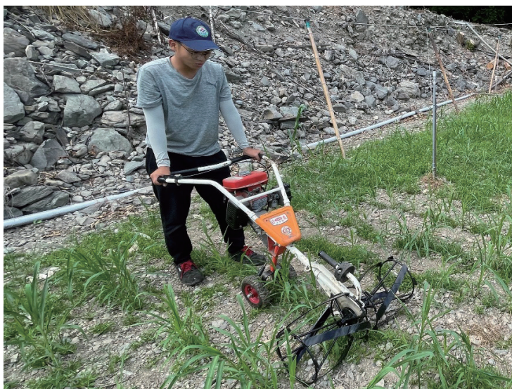
圖4. 雙行式糧雜行間除草機田間作業情形。 Fig. 4. Double row weeder.
