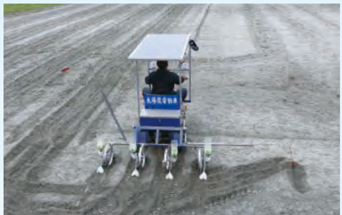
圖4. 本場研發之四行附掛式雜糧播種裝置附掛於太陽能車田間作業情形
