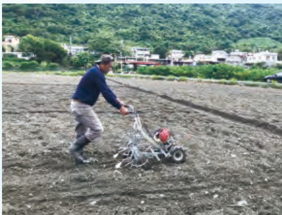
圖1. 本場研發之自走式小粒徑種子播種機的田間作業情形
