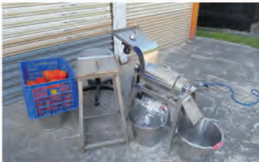
圖1. 本機械由固定切臺、旋轉刮刀及假種皮分離機組成
