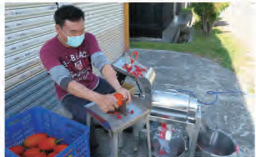
圖2. 機械作業以雙手握木鱨果將之推向固定切臺切成兩半之情形
