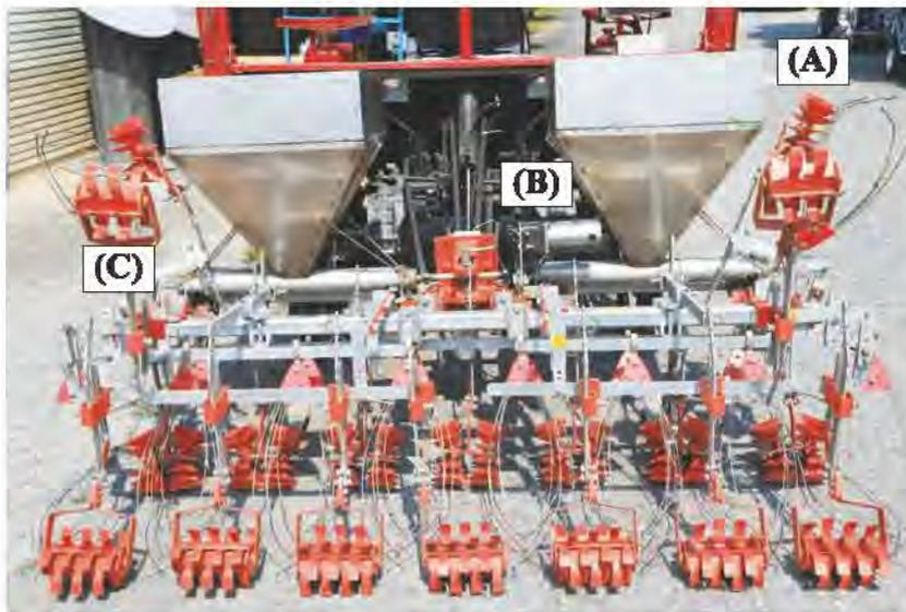
圖2. 施肥機構以(A)不銹鋼肥料桶、(B)減速馬達及(C)螺旋輸送機組成。
