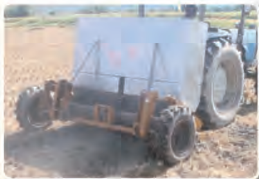
圖2. 曳引機附掛撒布機施用稻殼生物炭省工又降低揚塵
