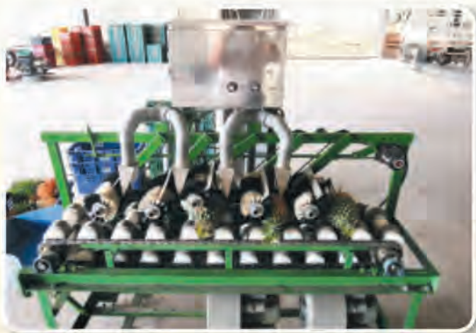
圖1. 研成之鳳梨表面清潔裝置於集貨場試驗情形
