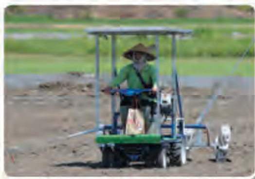
圖4. 太陽能乘坐式雜糧播種機田間播種情形
