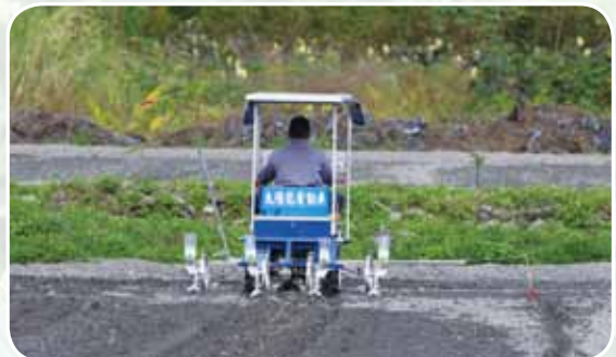
圖 2. 畫線器可方便農友在田間進行隔行播種定位之依據
