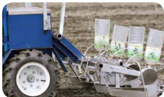
圖 3. 播種後透過覆土機構直接覆土於小米種子上
