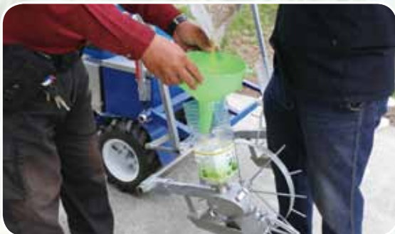
圖 1. 太陽能乘坐式播種機播種部可簡單快速添加小米
