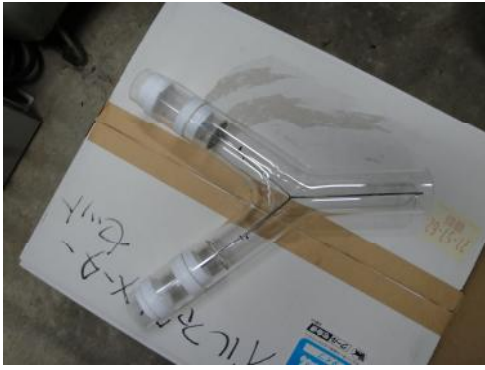
圖 13. Y 形管進行捕食性天敵氣味偏好試驗
