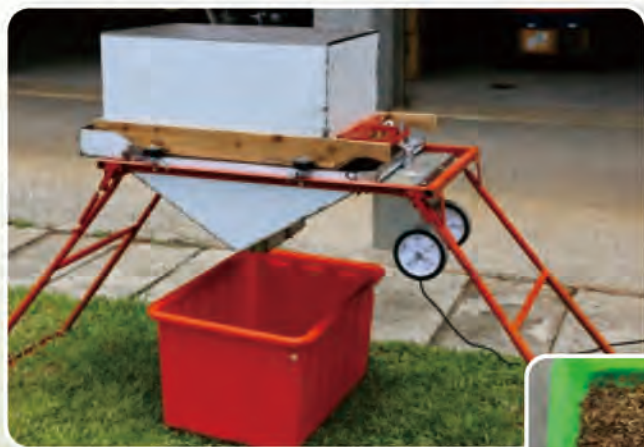
圖11.臺灣藜籽穗置於篩選機快速進行篩選，較人工篩選快速。
