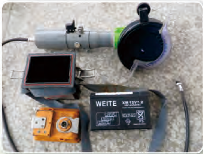
圖13. 果園大枝條修剪機組成結構
