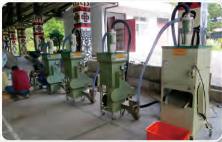
圖8. 本場研發之小米脫粒脫殼一貫化作業省工機械
