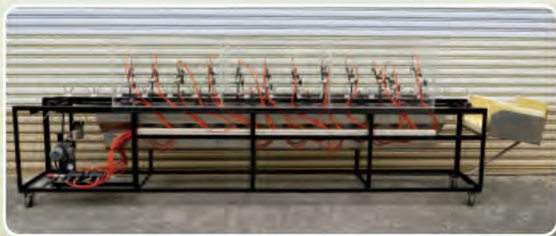
圖15. 研製完成之氣吹式之鳳梨釋迦粉介殼蟲清除機械
