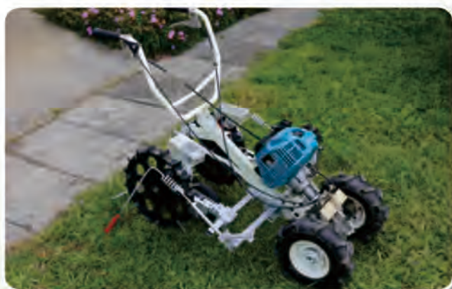
圖1. 自走式小粒徑種子播種機外觀
