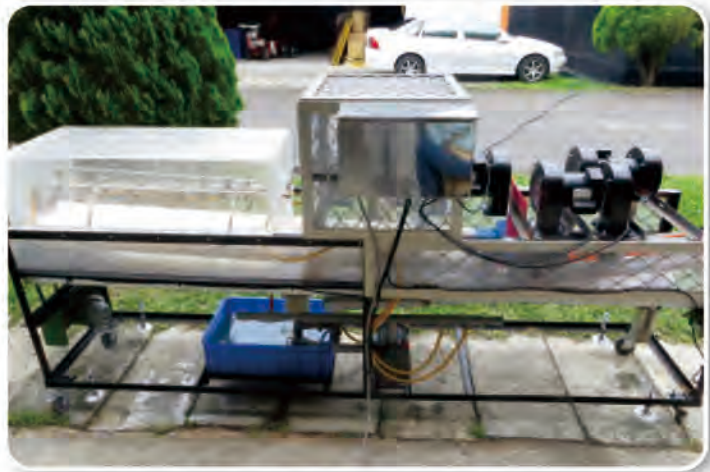
圖14. 研製完成之水洗式鳳梨釋迦粉介殼蟲清除機械
