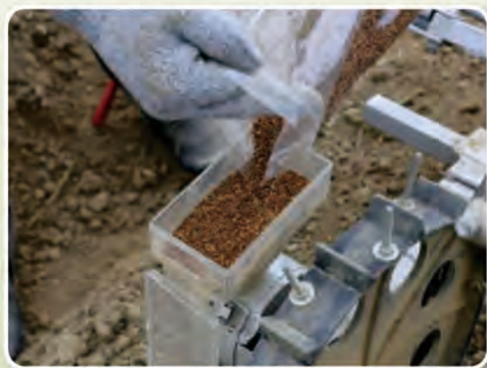
圖5.以小粒徑種子播種機加入臺灣藜種子情形
