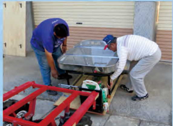
本裝置所有結構集中於搬運車載臺，只需2人即可安裝搬移，且不需使用工具。
