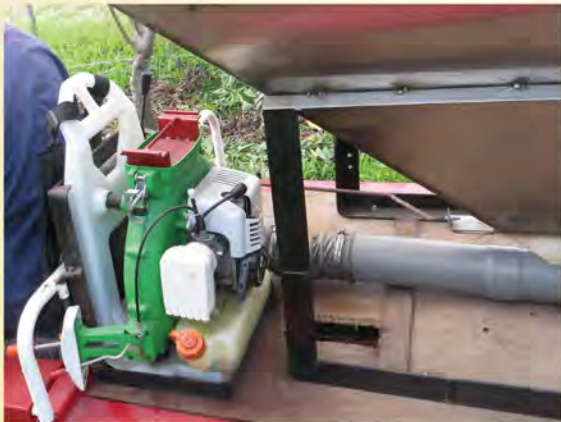
圖3. 撒布裝置施肥時以動力撒布機為動力
