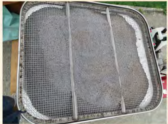
圖 7. 肥料桶上方設置不鏽鋼網篩除結塊之肥料
