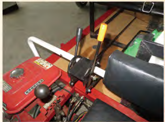
圖 8. 駕駛座旁具肥料量及 Y 形撒布管閘門控制桿
