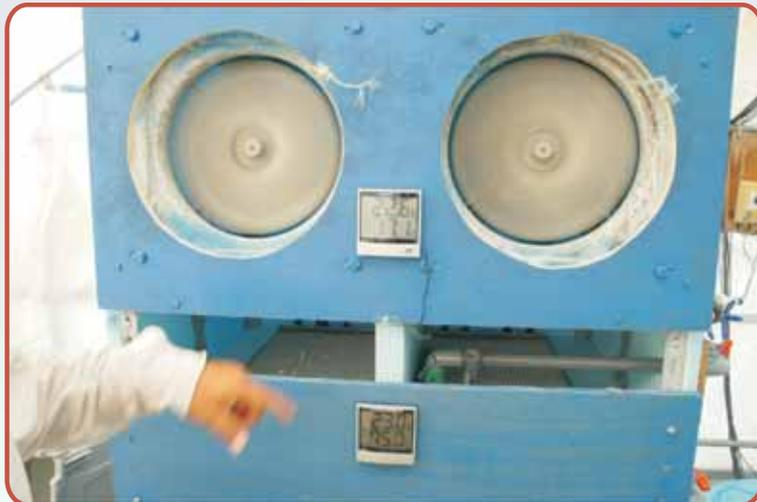
圖3. 車用散熱片與風扇改裝的冷氣機
