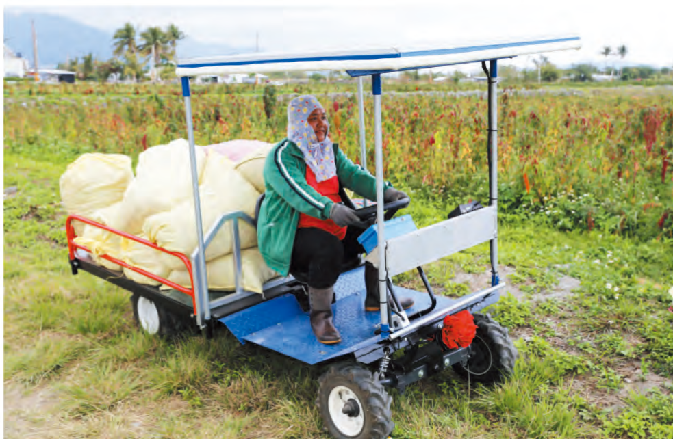
圖3. 太陽能電動搬運車駕駛方式與開車相同
