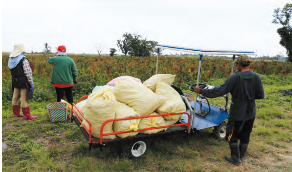
圖4. 電動搬運車後方貨臺可放置農作物或小型農機具
