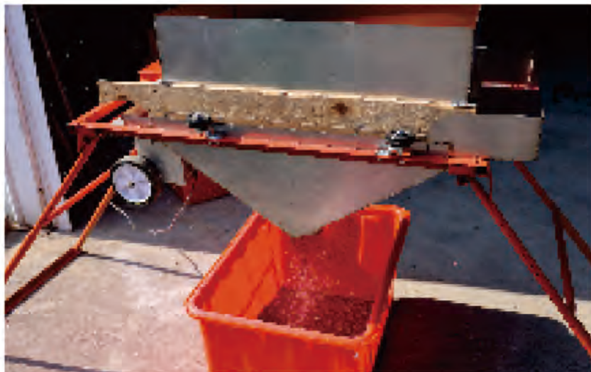
圖5.臺灣藜籽穗置於篩選機快速進行篩選，較人工篩選快速。
