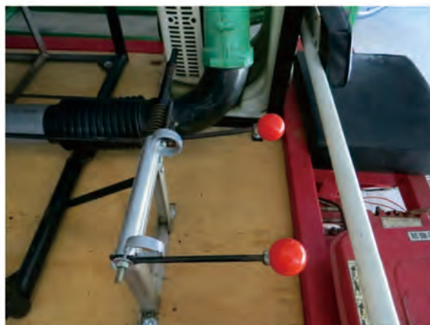
圖6. 肥料閘門控制桿(上)與左右調整閘門控制桿(下)
