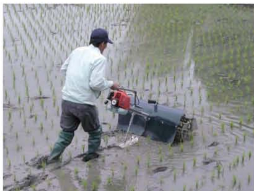
圖4. 浮船設計增加支撐力
