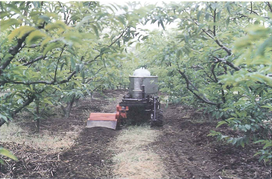
圖四、果園中耕施肥機從事樹冠下中耕除草施肥一貫作業
