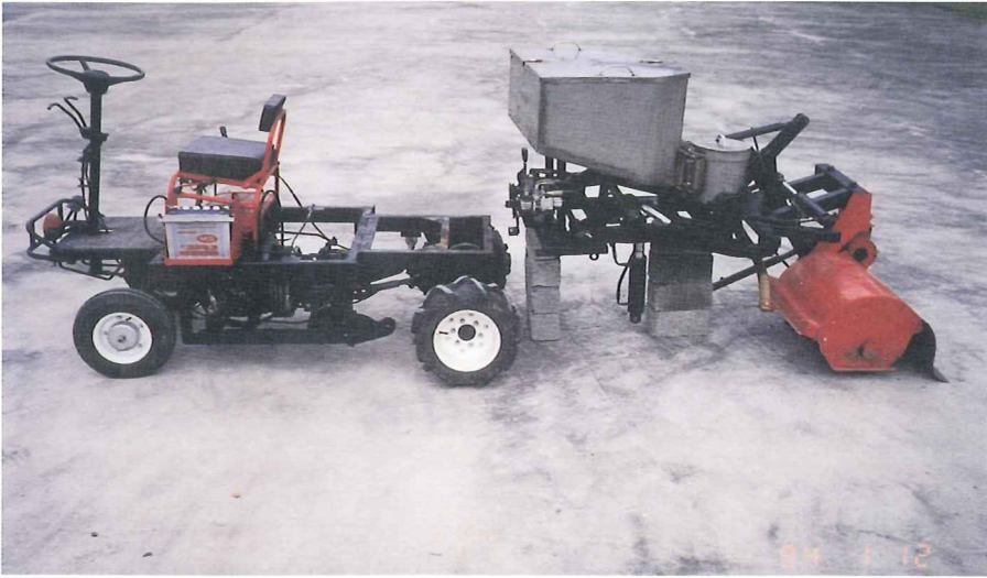
圖三、果園中耕施肥機本機與中耕施肥機構之承架分離情形
