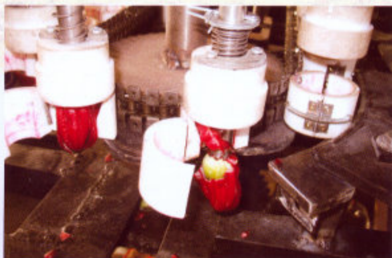
圖4.定位不良造成去籽刀具損傷花萼
