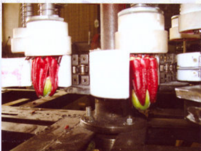
圖3.洛神葵去籽機去籽作業情形
