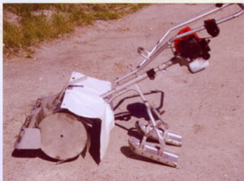
圖3. 本場研製具動力水田中耕除草機之機體結構
