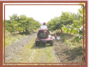
圖5、果園側移中耕除草機中耕部伸入果樹冠下作業情形
