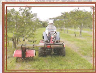
圖2、果園側移中耕除草機二段式側移機構水平方向移動
