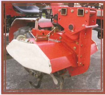
圖3、果園側移中耕除草機之中耕除草機構及刀具
