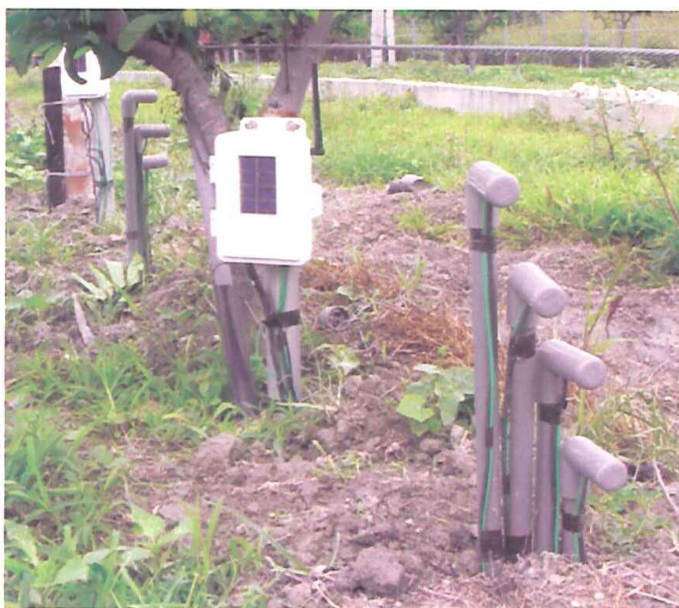
圖2. 土壤水分計田間安裝情形
