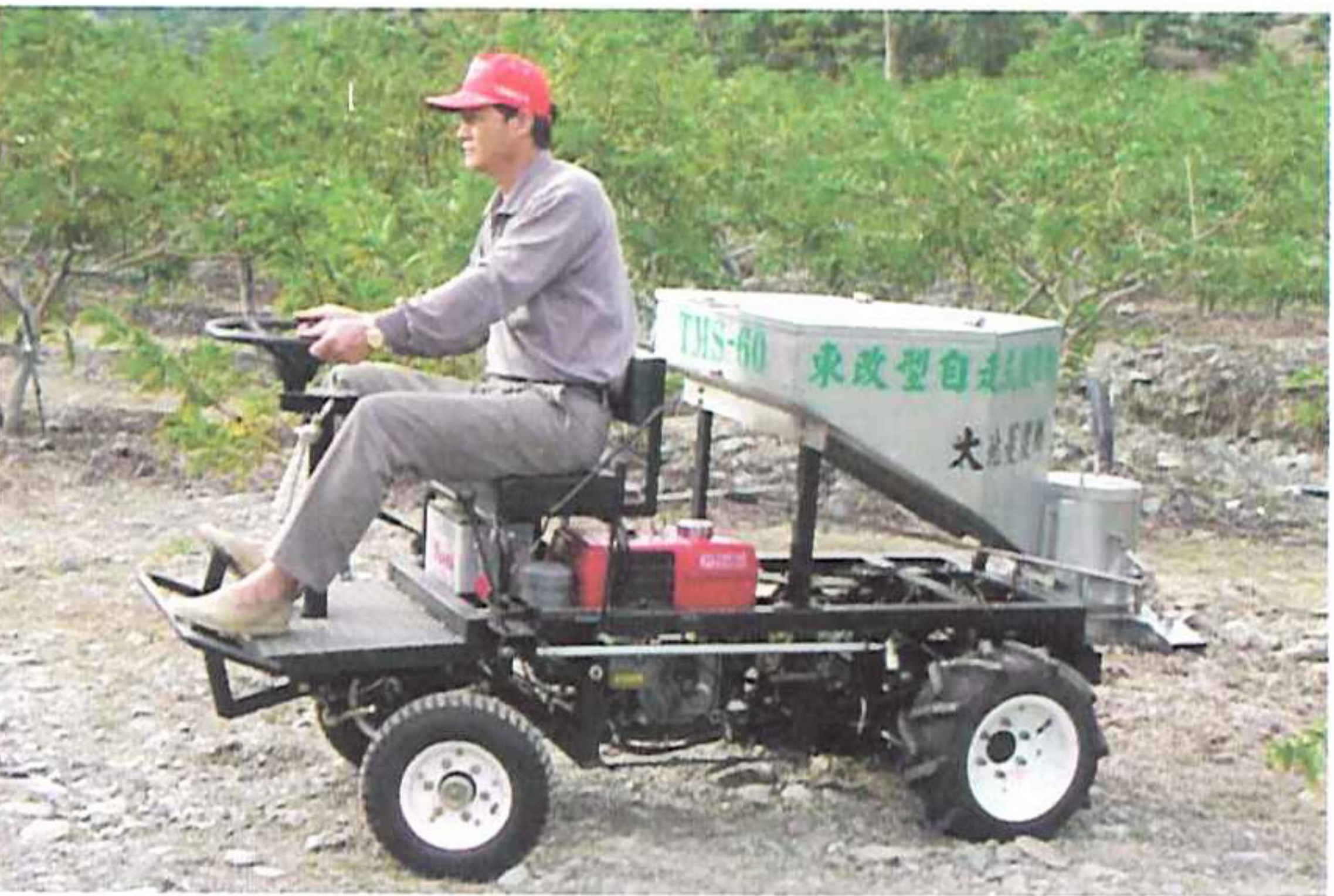
■圖二、自走式施肥機之構造
