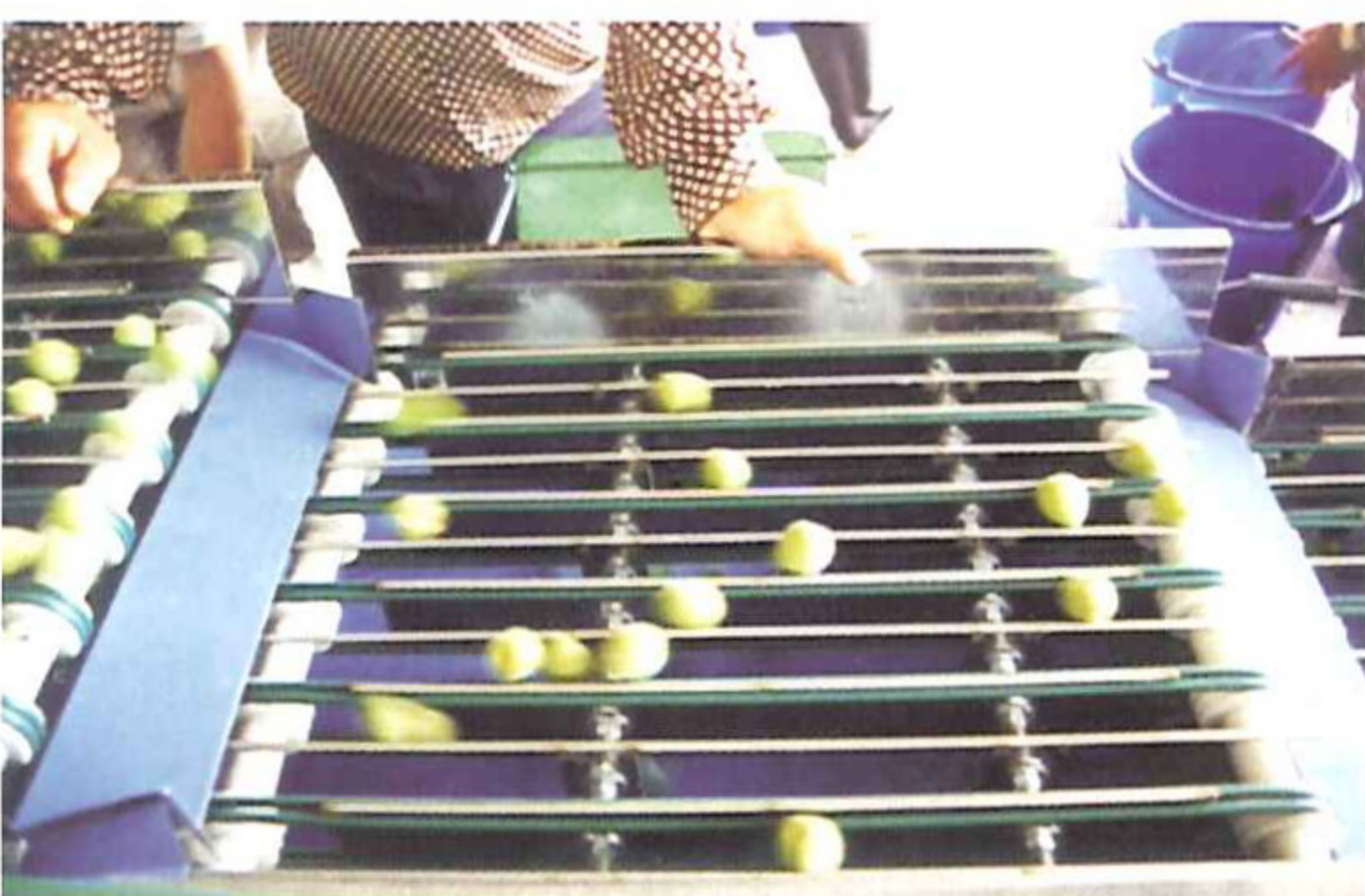
圖二、分級機構之圓皮帶、不銹鋼鐵條及扁鐵排列狀況
