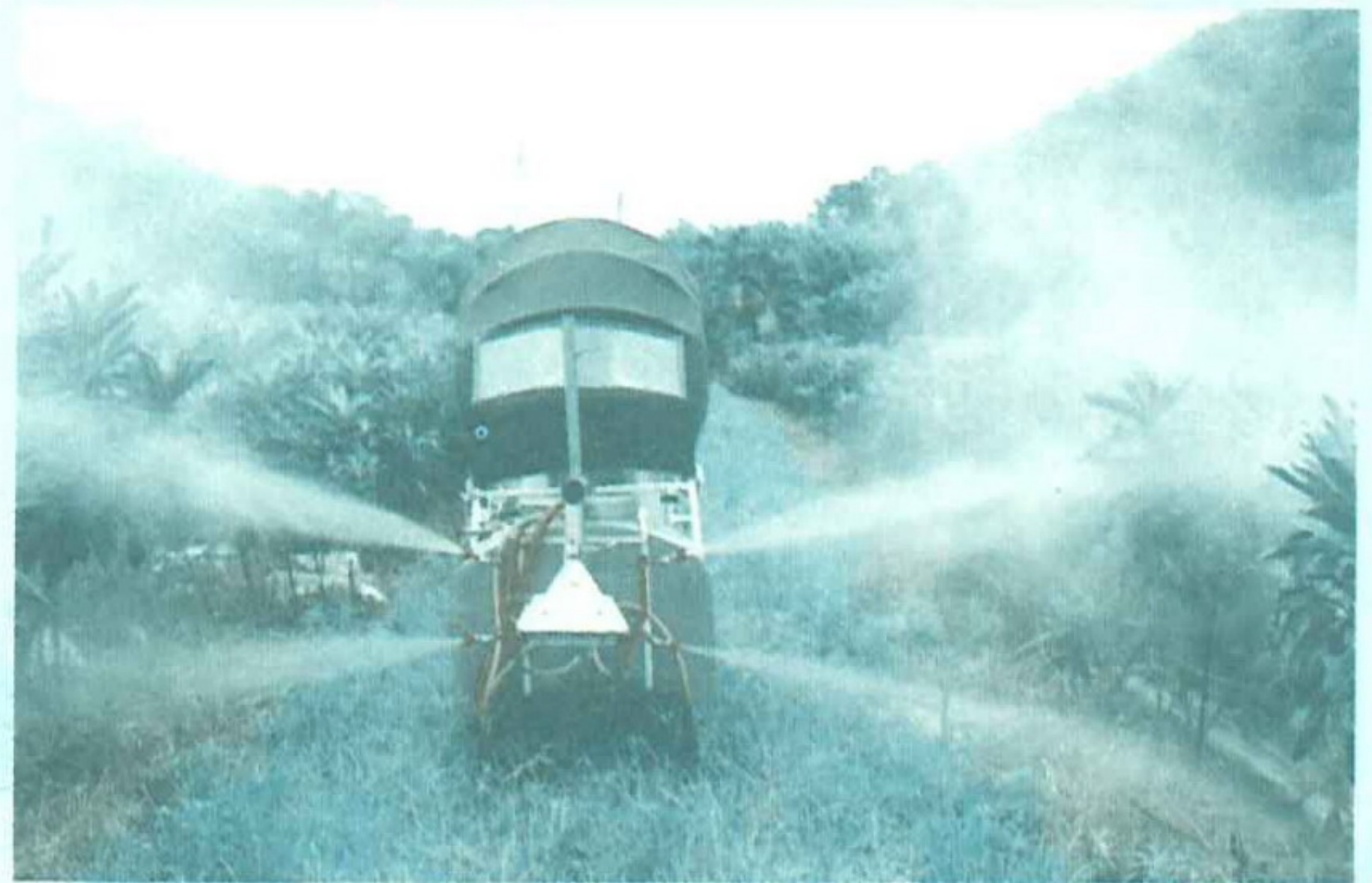
圖三、按裝弧形保護罩之擺動噴頭式履帶噴藥機
