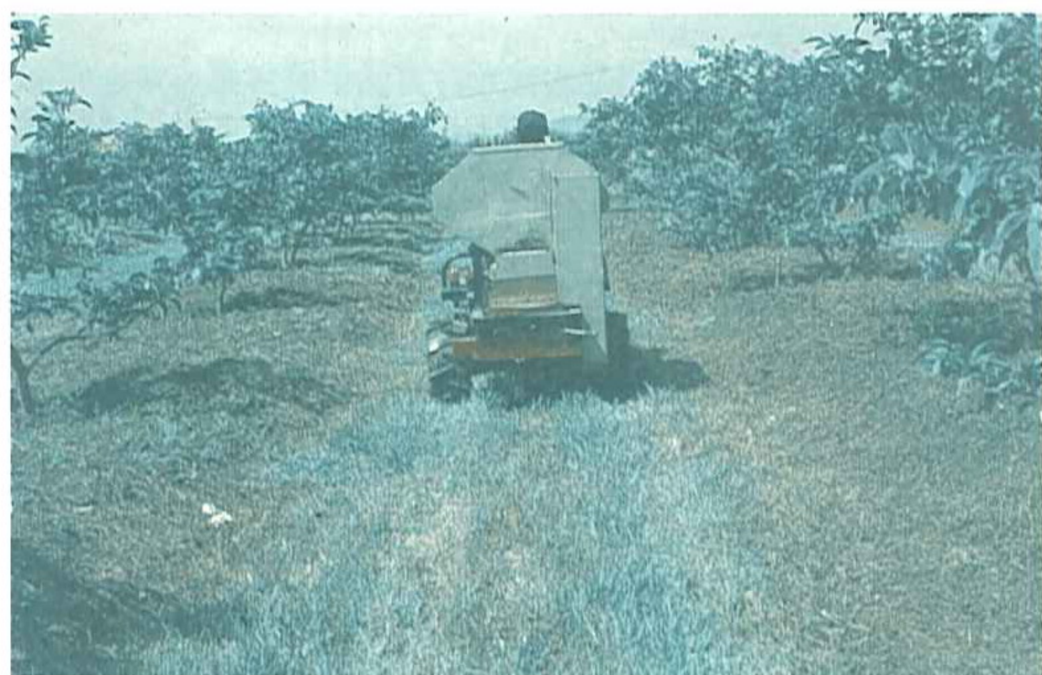
施肥盤將肥料向兩側噴施
