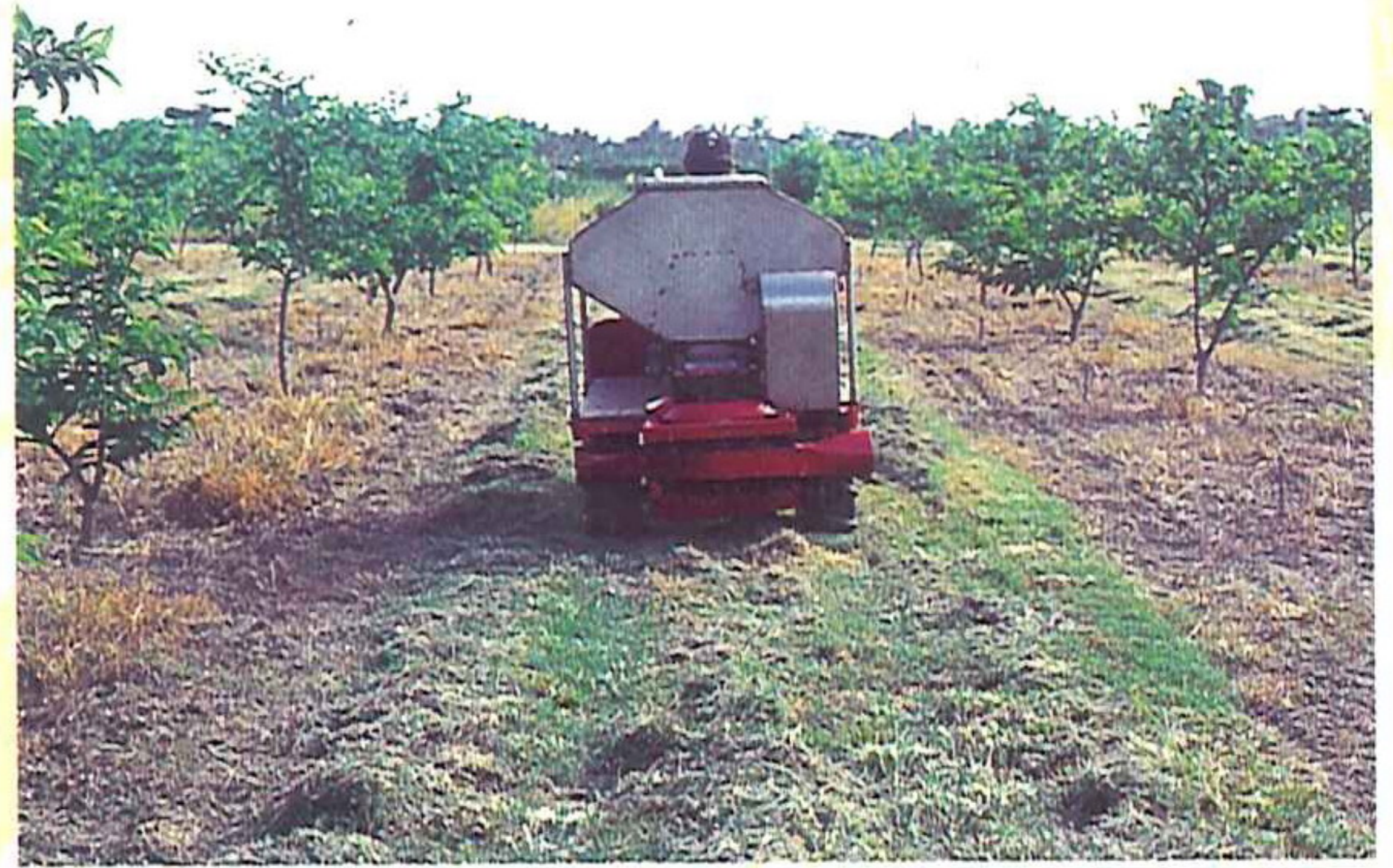
圖三、果樹追肥撒布機撒施粒狀複合肥料作業情形
