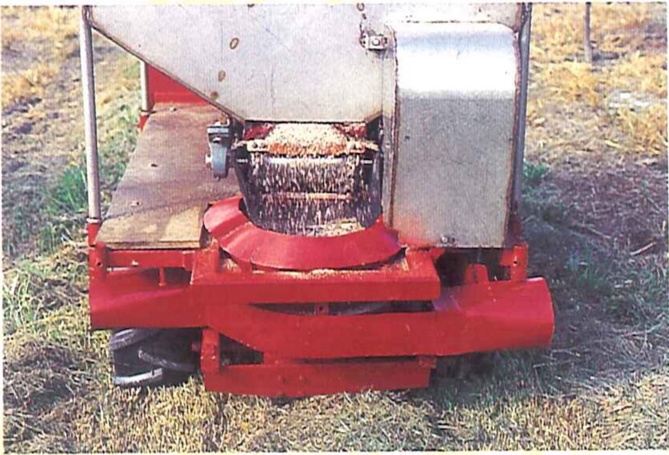
圖二、肥料輸送至肥料配出盤
