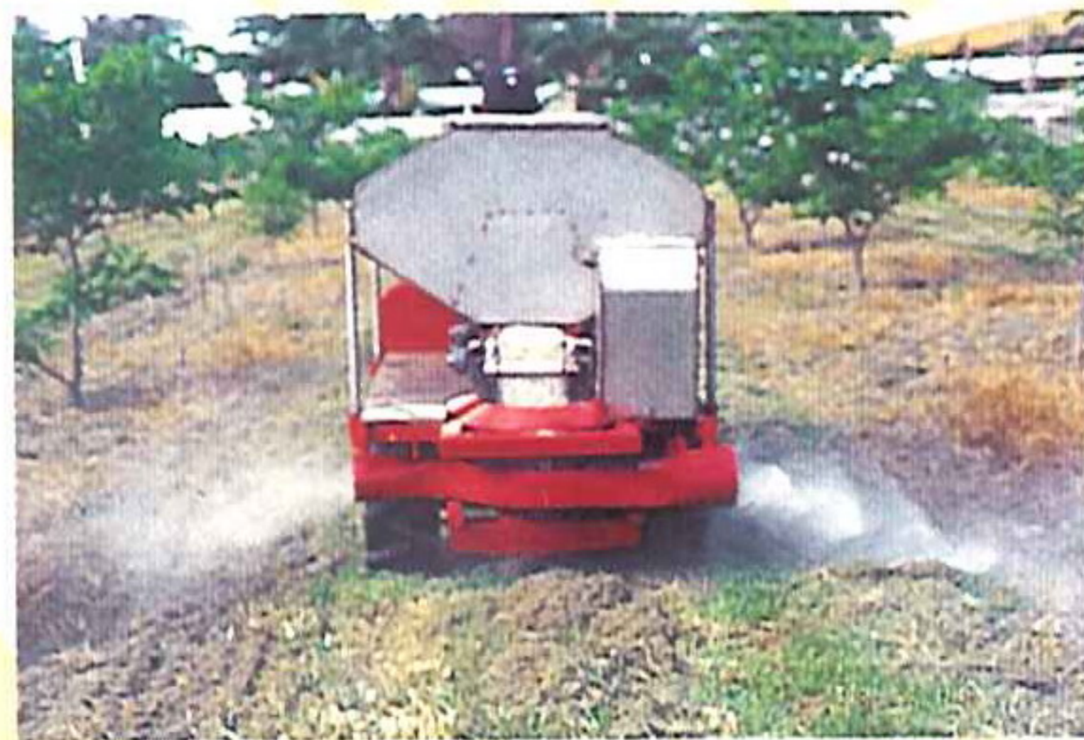
圖四、果樹追肥撒布機撒施粉狀肥料作業情形
