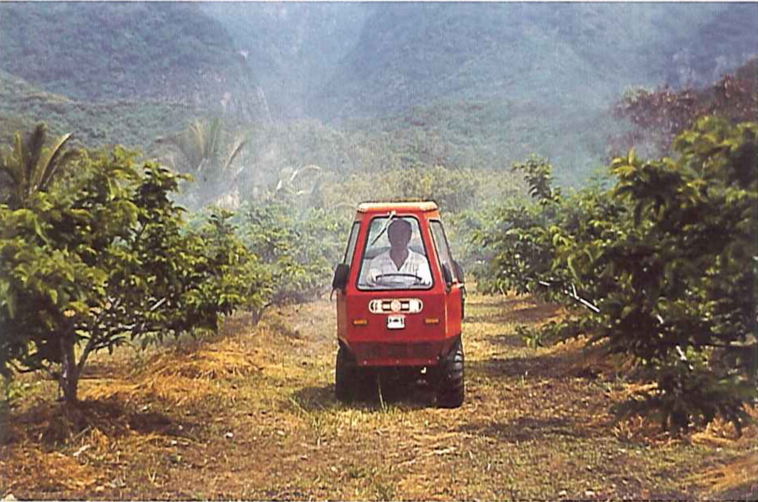
圖一、保護罩自走式鼓風噴霧車果園噴藥作業示範
