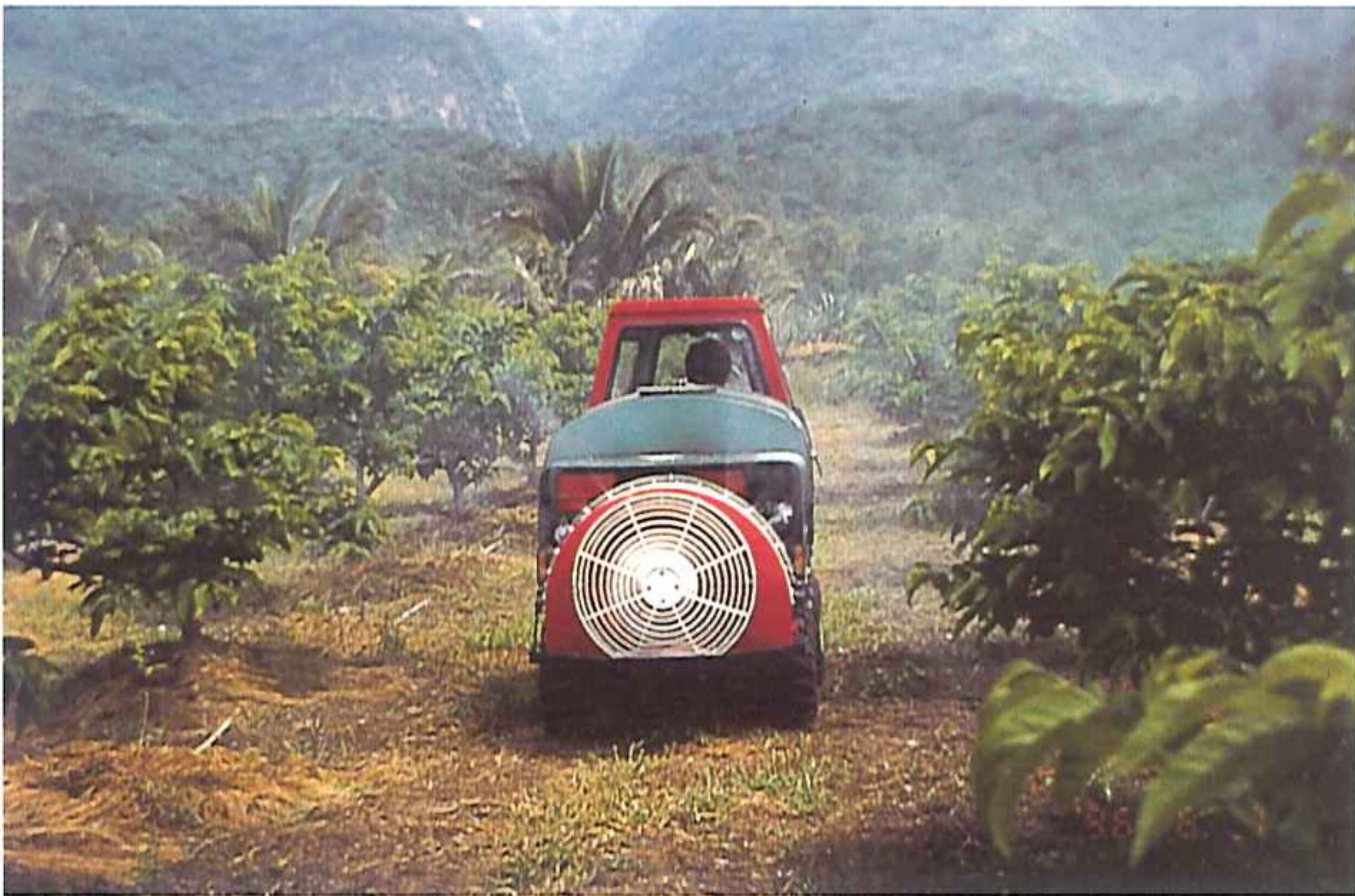
圖二、保護罩自走式鼓風噴霧車鼓風式噴藥撒佈霧粒微細化、節省農藥
