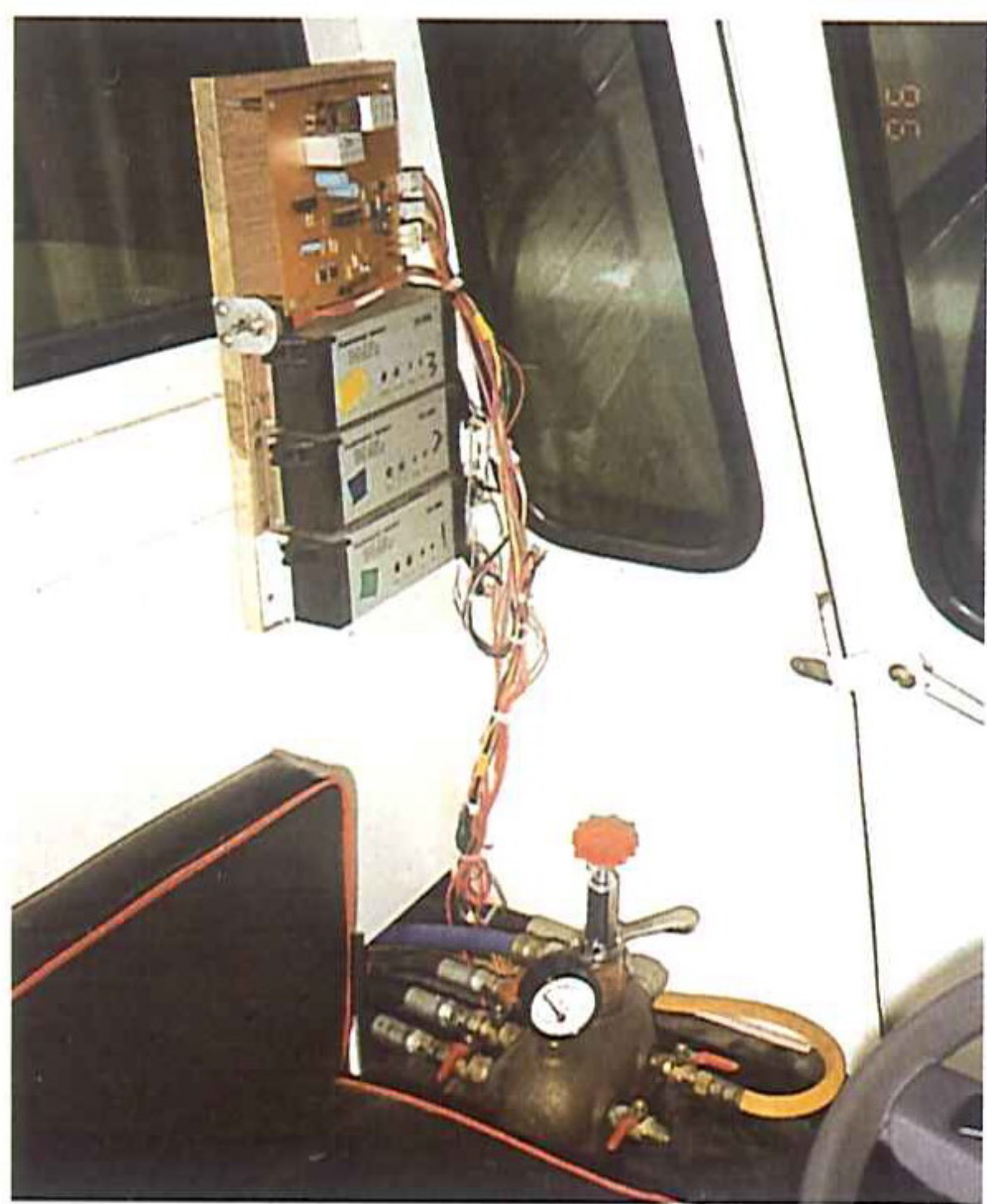
圖二、點噴式施藥車所使用之 I C 電路控制板
